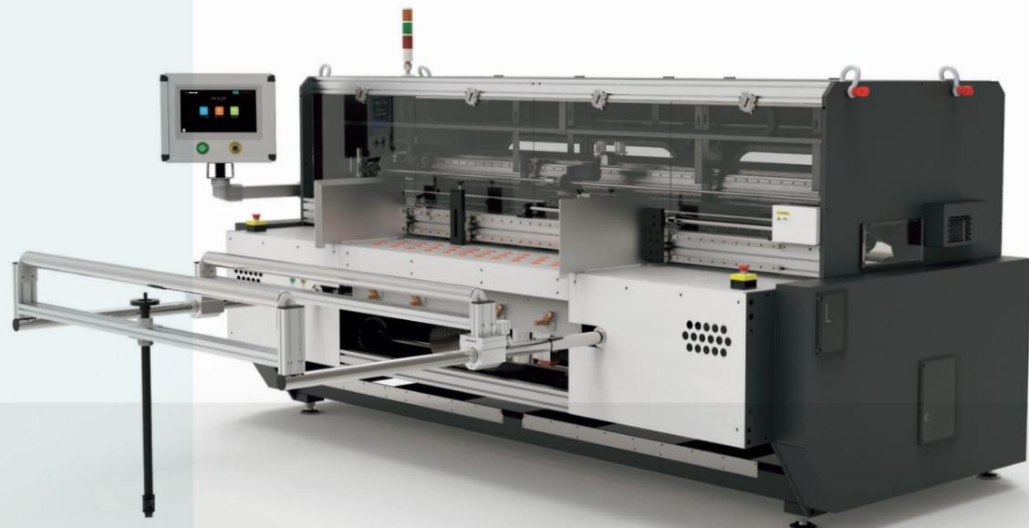
専用タッチパネル※<sup>1</sup>に形状とサイズを入力するだけでダンボールケースの生産を可能にします。通販物流の出荷梱包現場やEコマースに対応した、極小ロットでの短納期出荷に最適なダンボールケース作成を可能にするマシンです。
